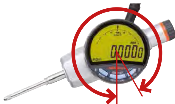
Mécanisme de rotation à 330°
